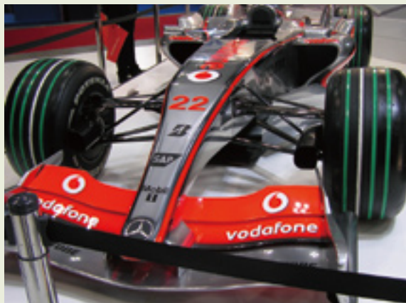
▲ CFRP で作られた F1 レース車両 (車体重量は約 620kg)
